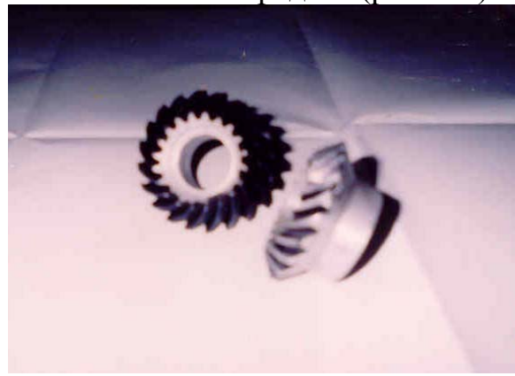
Рис. 11. Проверка пятна контакта после обкатки конической передачи.
